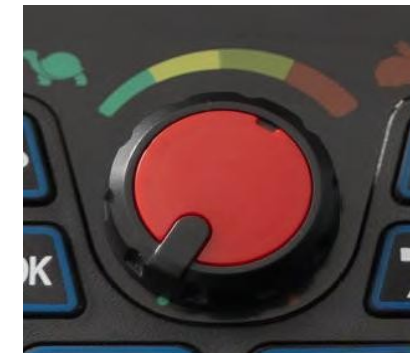
Figur 8 – Begränsare för maximal hastighet
