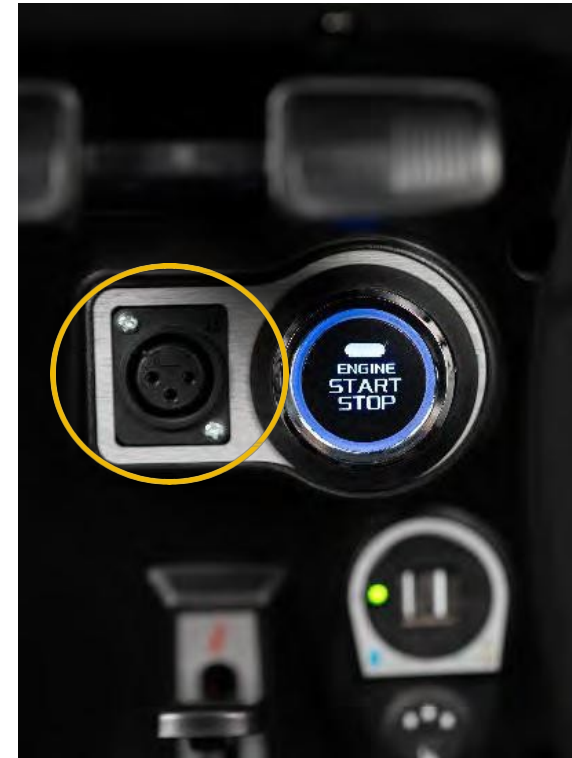
Figur 19 – Laddningsport monterad på styret
